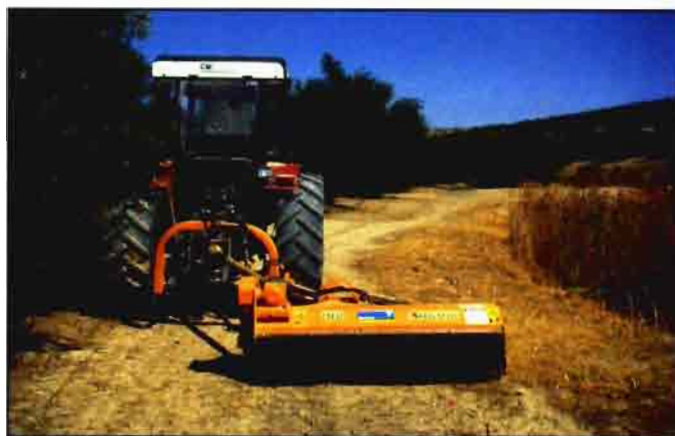
Desbrozadora mecánica desplazable del centro del tractor. Se trata de una excelente herramienta para el control de hierbas en olivar, alternativa muchas veces a los herbicidas
