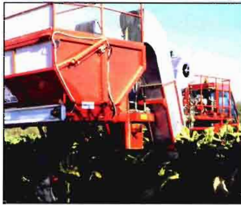
Fig. 12. Parte posterior de la cosechadora Mantovani con tubos de transporte neumático de hojas y tolva.
