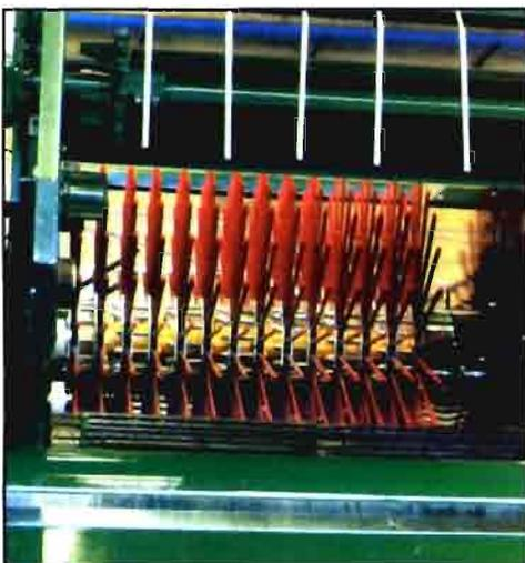
Cilindro separador vibratorio de radios.
