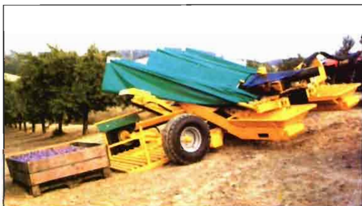
Vibrador y paraguas Cepparo sobre una plataforma arrastrada en la que también cabe un cajón.
