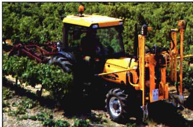
Tractor Renault Dionis 140 con un apero montado delante y otro detrás.
