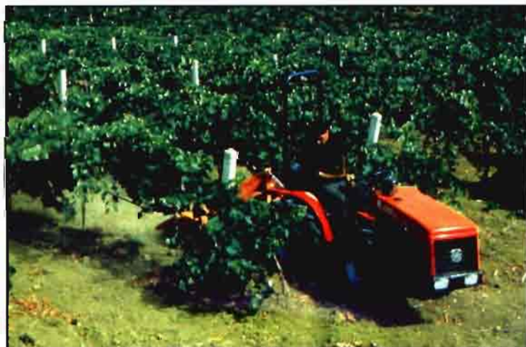
Tractor Carraro Supertigre Vigneto articulado en el momento de iniciar una curva.
