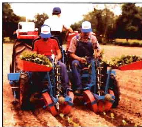
Figura 7. Transplantadora de alimentación manual con dispositivo de pinzas sobre cadena vertical (Ribouleau - Monosem).
