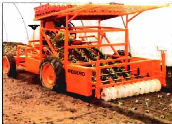
Figura 8. Transplantadora de alimentación automática de cinta transportadora (Regero).
