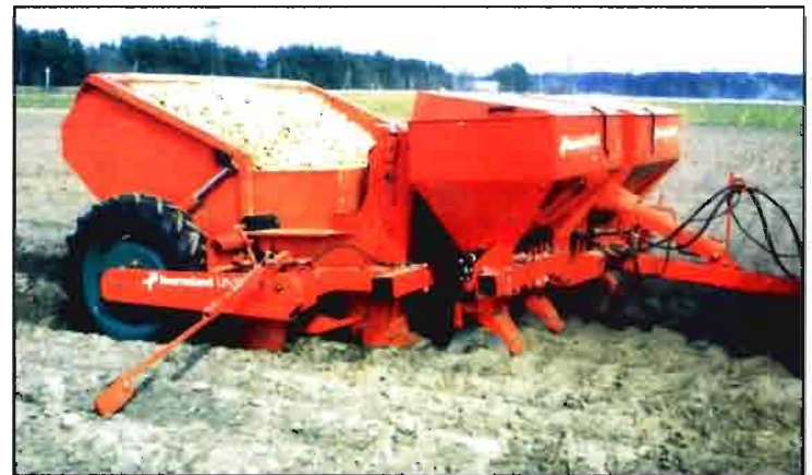
Figura 3. Plantadora de patatas totalmente automatizada en cuatro líneas (Kverneland). Dispone de tolva hidráulica, dispositivo adicional de fertilización y trazador de huellas.
