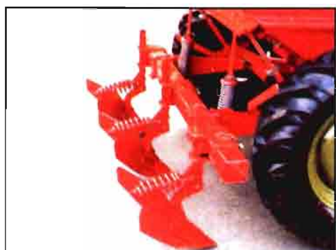
Figura 4. Rejas aporcadoras (izda., Kverneland) y discos alomadores (dcha., Monosem).
