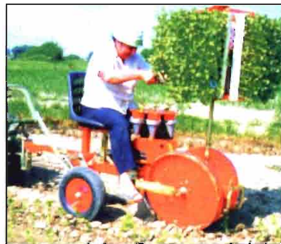
Figura 6. Transplantadora de alimentación manual con dispositivo de vasos sobre eje vertical (Checchi & Magli - Agrotiétar).
