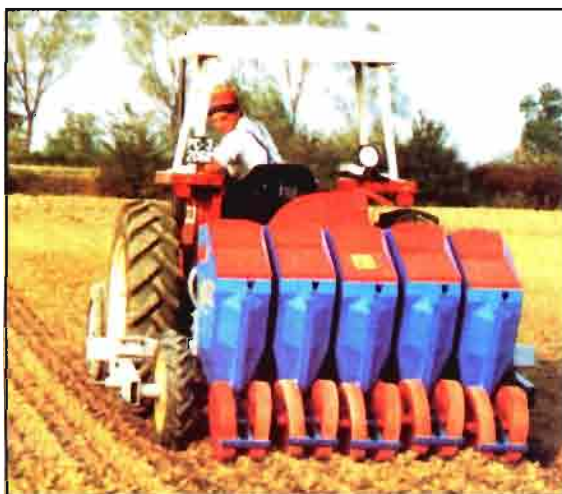
Figura 5. Plantadora de ajos, chalotas y bulbos totalmente automatizada (Société Rock - Navarro Andueza)
