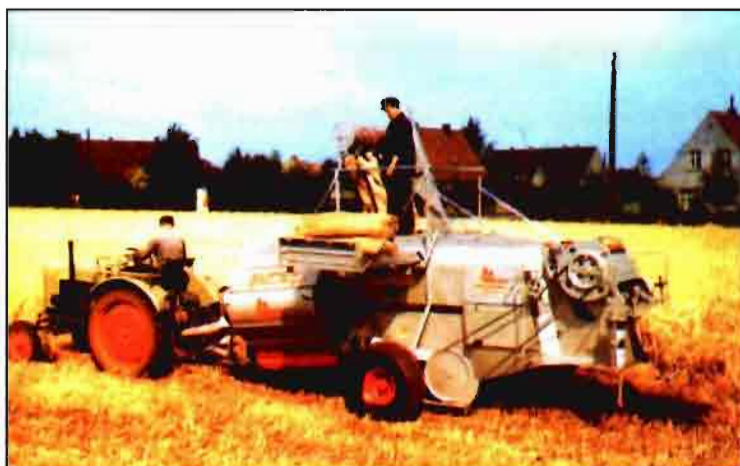
F. 3. Cosechadora arrastrada de flujo longitudinal-transversal (1946, Claas Super).
