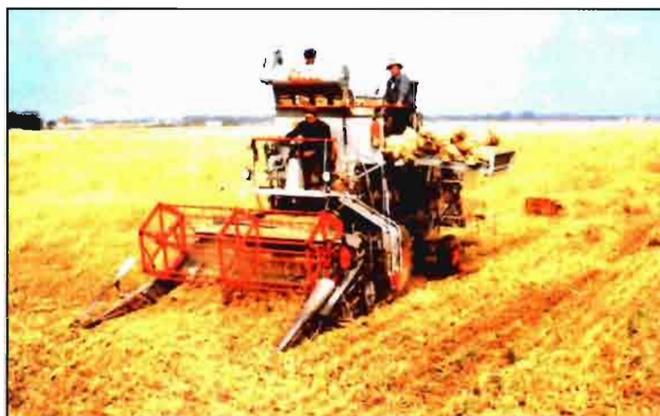
F. 4. Las cosechadoras autopropulsadas aparecieron en Europa alrededor de los años 50 (Claas SF).
