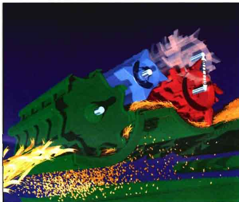
F. 6. Conjunto del mecanismo de trilla: cilindro desgranador (verde) sobre el cóncavo, cilindro lanzapajas (azul) y cilindro adicional de separación rotativa (rojo) que puede ser ajustado en altura (turboseparador Deutz-Fahr).
