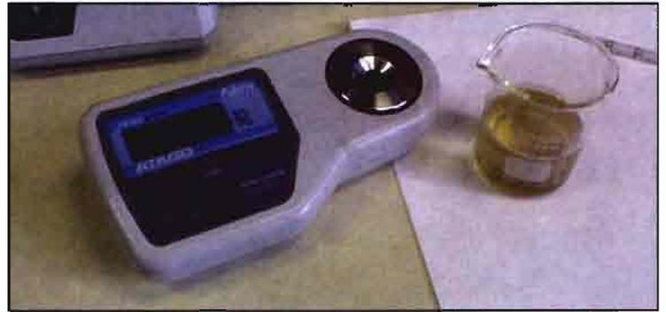
Refractómetro para medir el contenido de azúcares.
