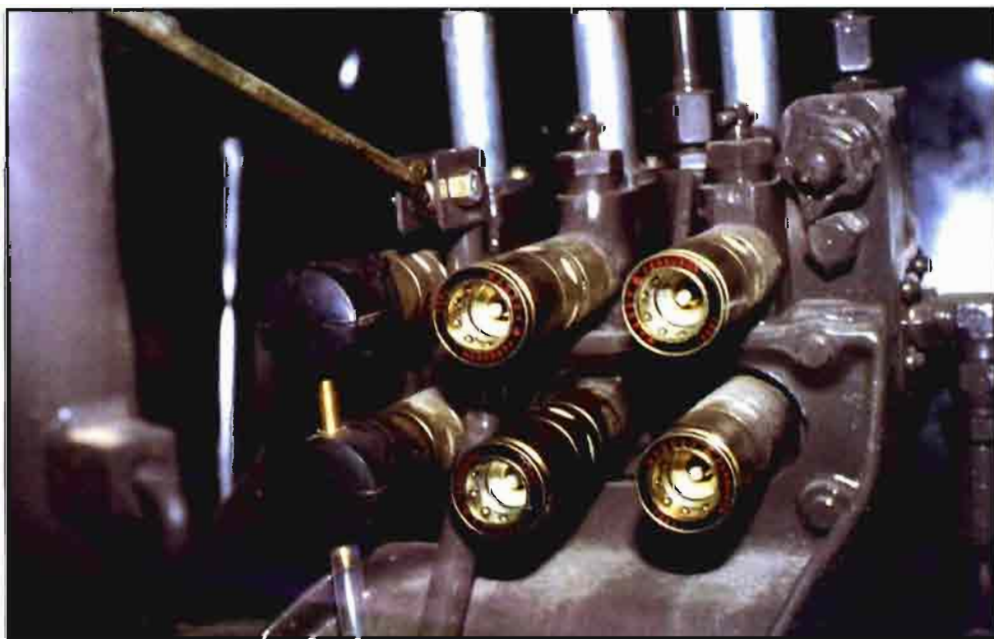
Figura 4.- Los acoplamientos rápidos del tractor deben mantenerse limpios para que no penetre suciedad en el circuito cuando se conectan las tuberías del aparo.
