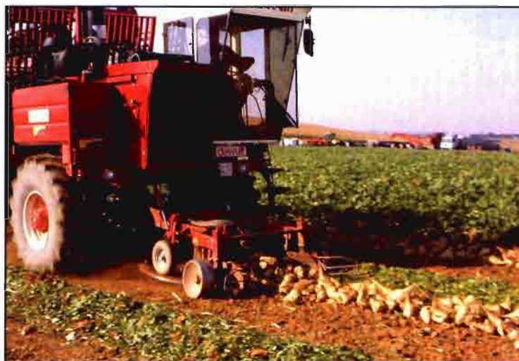
Recogedora De Wulf pasando sobre la hilera de remolachas ya arrancadas.
