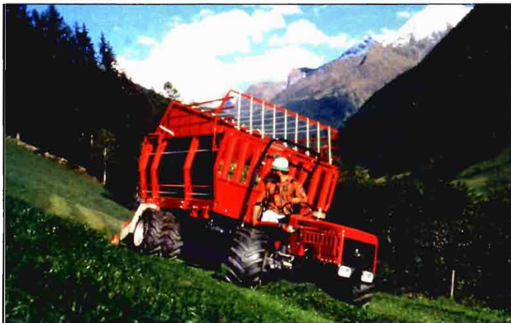
Los trabajos en pendiente aumentan el riesgo de vuelco en los tractores, reducido gracias al arco de seguridad.
