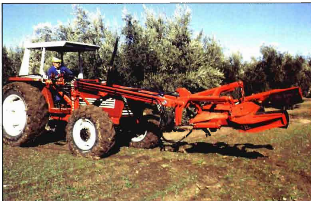
Figura 1.- Vibrador montado en la parte delantera de un tractor de doble tracción.
