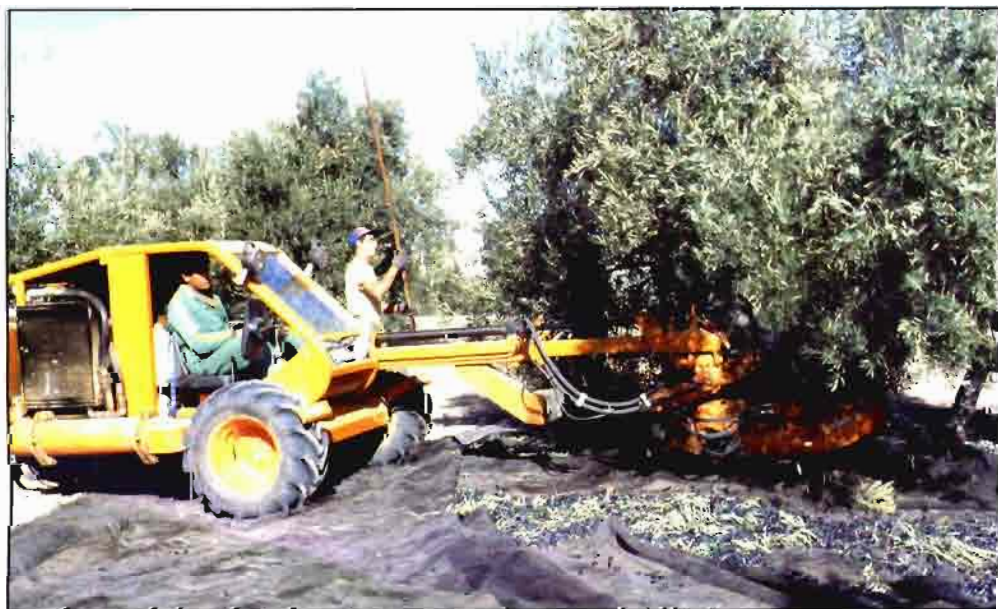
Figura 2.- Vibrador autopropulsado, con un vehículo especialmente diseñado para maniobrar entre los árboles.
