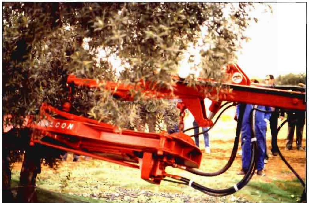
Figura 5.- Vibrador con el motor hidráulico y sus tuberías en la parte inferior, protegido con una chapa.
