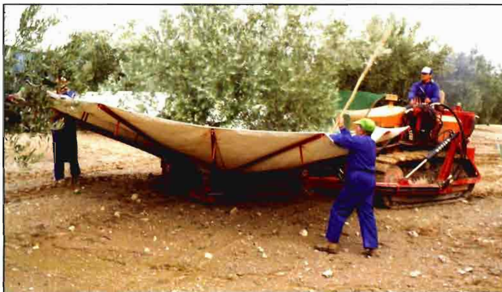
Figura 7.- Paraguas invertido bajo la copa de un olivo de un pie. El vibrador está agarrando al tronco, oculto por el paraguas.
