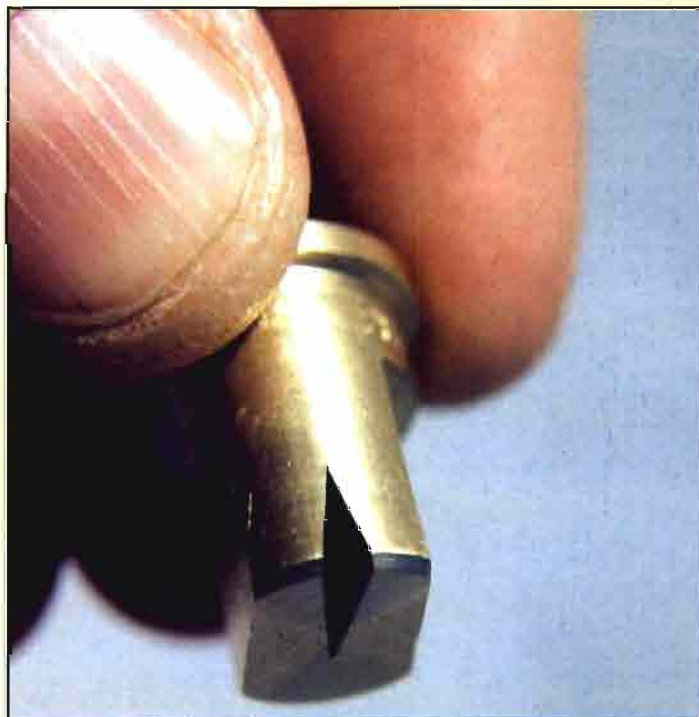
Boquilla de chorro excéntrico, útil para ser colocada en el extremo de la barra. Es importante la colocación de la boquilla, para que la calidad del tratamiento sea adecuada. En la fotografía, aparece la ubicación correcta en la barra, colocando la salida hacia arriba.
