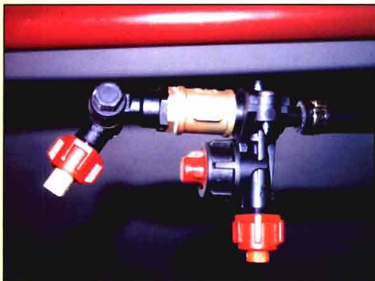
Detalle de la ubicación de las boquillas en el extremo de la barra. En el centro, boquilla de chorro centrado, ubicada en un portaboquillas con dispositivo antigoteo. A la izquierda, portaboquillas de rótula con boquilla de chorro excéntrico que permite tratar una anchura entre 1,5 y 2,0 m., según fabricante o modelo.
