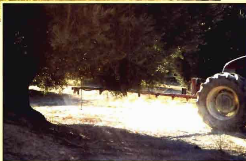
Barra para aplicación de herbicidas en olivar, muy bien adaptada para entrar bajo la copa de los árboles sin romperse y dotada de boquilla de chorro excéntrica en el extremo para hacer llegar el "caldo" entre los troncos.
