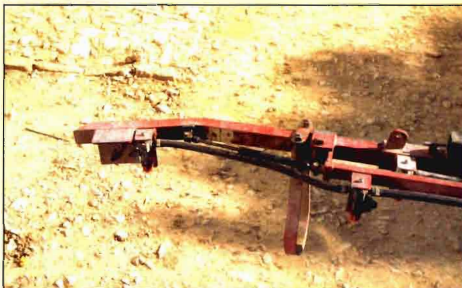
Extremo de la barra dotada de mecanismo que permite doblarse ante el impacto con las ramas bajas y recuperar su posición inicial mediante el correspondiente mecanismo de extensión. En el extremo se coloca la correspondiente boquilla excéntrica con un portaboquillas de rótula que permite colocar dicha boquilla con el ángulo recomendado por el fabricante.
