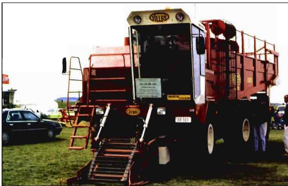
Remolque autocargador de remolacha.
