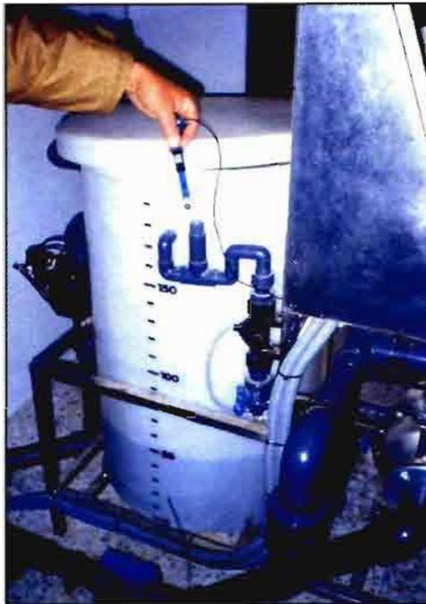
Sensor de pH -arriba- y conductividad -abajo- en una instalación de fertirrigación (Madrid).
