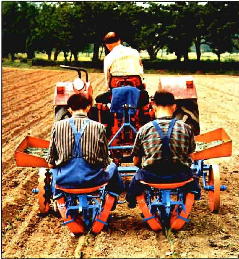
Figura 4.- Modelo antiguo de trasplantadora cuya única tarea es depositar en el terreno plantitas con raíz desnuda.
