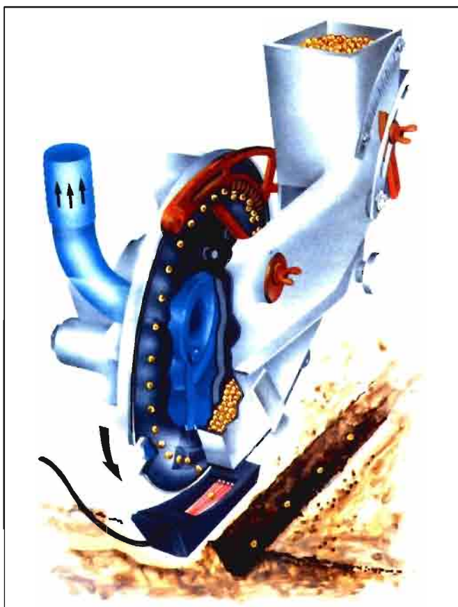
Figura 1.- Extracción de las semillas de una en una del fondo de la tolva en las sembradoras neumáticas.
