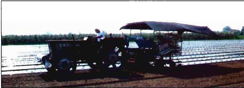
Figura 6 (arriba).- Trasplantadora que simultáneamente extiende un plástico para acolchar el cultivo.
