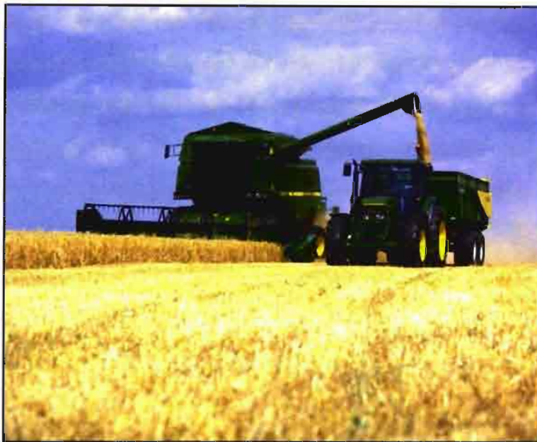
Las serie 2200 de John Deere tiene una alta capacidad de descarga: 4.300 L/min.
