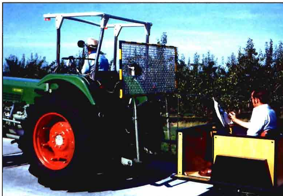
Fig. 1. Medición de ruido en el oído del conductor.
