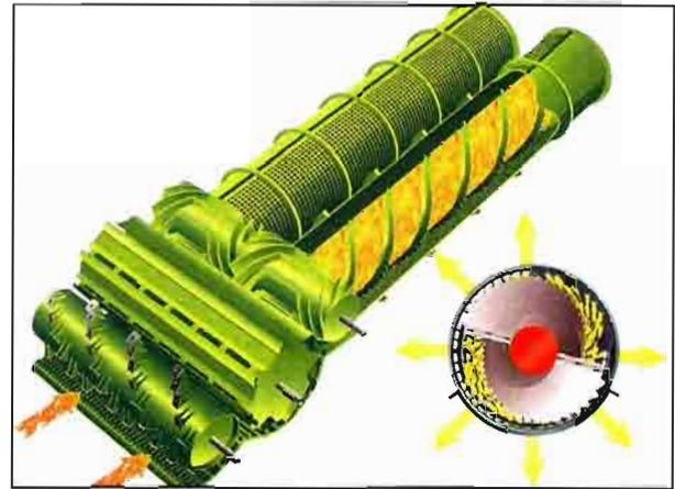
Los sistemas de separación de grano mediante cilindros rotativos longitudinales se van implantando durante los últimos años, en sustitución de los transversales.
