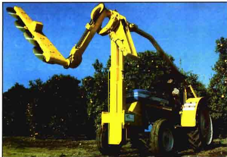
Fig. 1.- Barra de poda compuesta por cuatro discos de bordes dentados.
