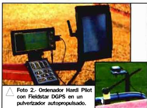
△ Foto 2.- Ordenador Hardl Pilot con Fieldstar DGPS en un pulverizador autopropulsado.
