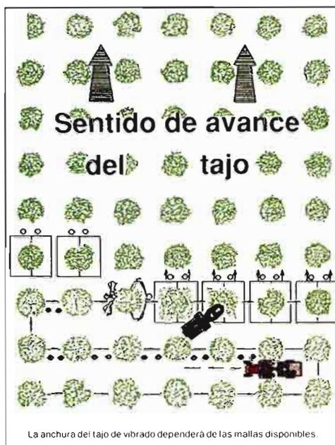
**F. 3.- Avance de la cuadrilla colocando mallas (hacia arriba en una anchura de, por ejemplo, siete filas de árboles) y del vibrador (a izquierda y derecha para vibrar todos los olivos de cada fila).**
