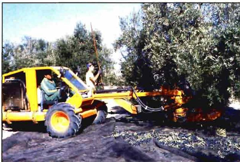
F. 7.- Máquina completa compuesta de vibrador montado sobre su propio vehículo.
