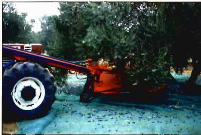
**F. 4.- Arriba, vibrador acercándose al tronco de un árbol bajo cuya copa ya están colocadas las mallas. F. 5.- A la derecha, vibrador y paraguas invertido acoplados sobre el mismo tractor, ideal para cosechar las aceitunas en olivos de un solo pie.**
