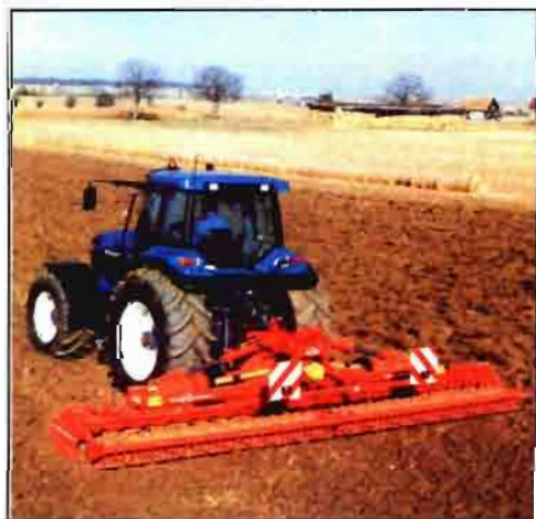
La clásica grada de discos, combinada en este caso con un rodillo, vuelve a verse en nuestros campos, con anchuras de trabajo considerables. En este caso una Gregoire Besson plegable hidráulicamente.
