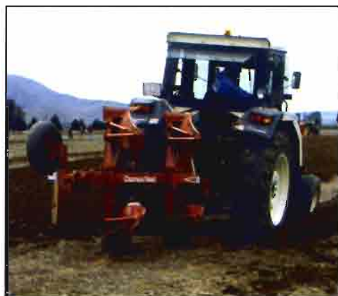
Arado de volteo hidráulico de Charrues Naud.
