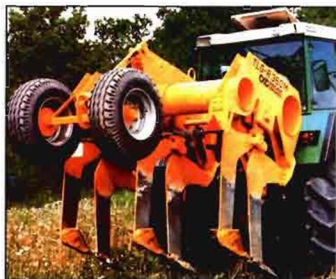
Alternativas poco conocidas, como este subsolador-vibrador, pueden ser interesantes en algunas circunstancias concretas.
