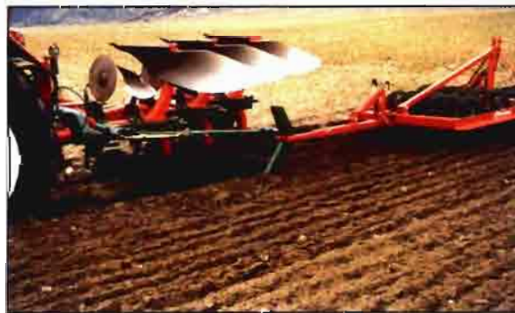
Una de las asociaciones de aperos más recientes y más interesantes es la del arado de vertedera reversible y el rodillo desterrador-compactador de Kverneland.
