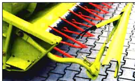
Detalle del divisor de mies abatido hacia el centro, preparado para cargar el cabezal sobre un remolque.
