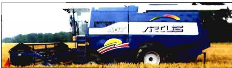
Vista lateral de la cosechadora MDW Arcus, en la que se aprecia que las ruedas delanteras son directrices y las grandes ruedas traseras son las motrices.
