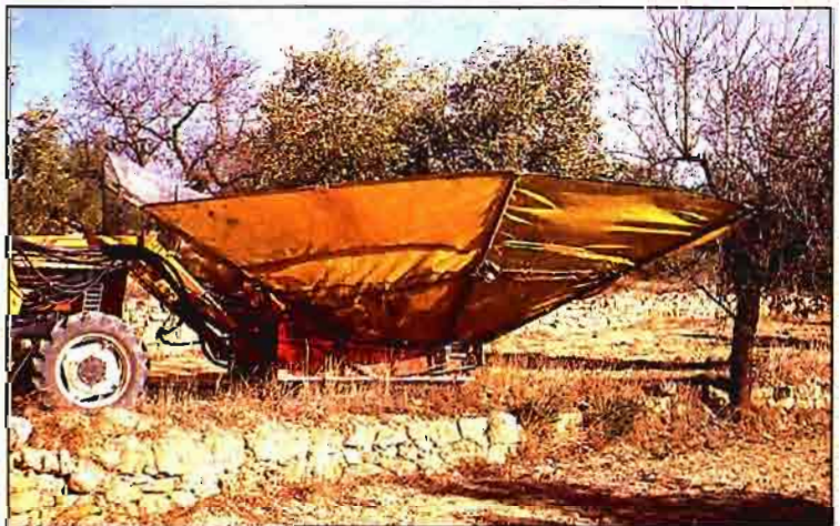
F.9. Conjunto vibrador-paraguas invertido montado en el mismo tractor.
