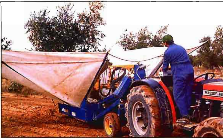
F.6. Vibrador unidireccional montado en la parte posterior del tractor.
