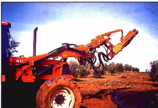
F.5. Vibrador multidireccional montado en la parte frontal del tractor.
