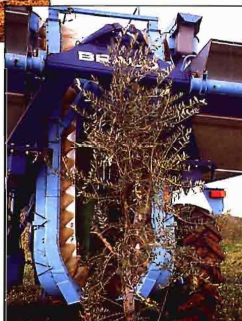
F.12. Vendimiadora utilizada para la recolección en continuo de la aceituna.
