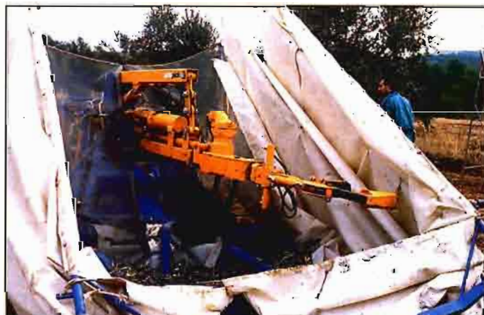
F.2. Vibrador de biela-manivela, tradicionalmente llamado vibrador unidireccional.
