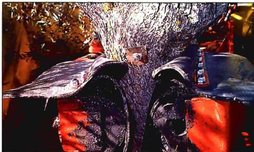
F.11. Sensor acelerométrico, para el estudio de las características de la vibración.
