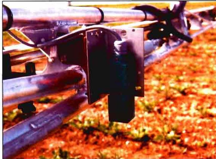
Fig. 2. Detalle del sistema electrónico Stabilor, de Hardi, que mide de manera constante la distancia de la barra de pulverización al objetivo.
