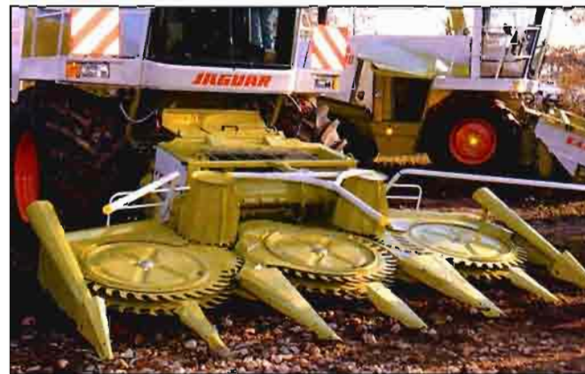
Fig. 6. El cabezal rotativo de Claas permite cosechar las parcelas de maíz sin necesidad de ajustarse a las líneas de siembra.
