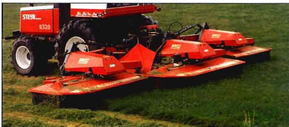
Fig. 2. Las segadoras de tambores PZ (Greenland) pueden ser dispuestas en tándem para abarcar anchuras de hast 8,7 m.
