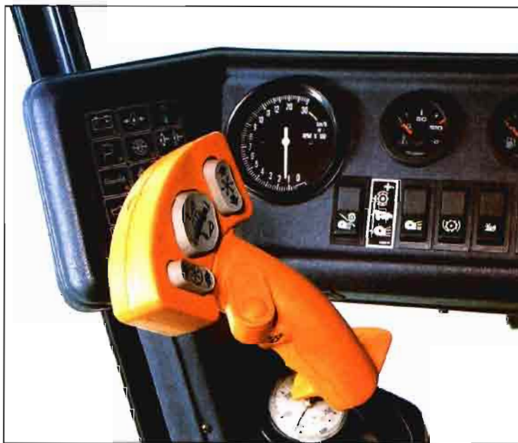
Fig. 4. Palanca multifunción y mandos de accionamiento del cilindro desgranador y del ventilador de limpia instalados en las cabinas de las cosechadoras TC de New Holland.
