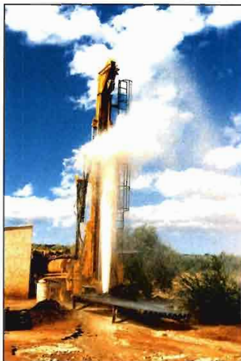
Aunque los ríos proporcionan la parte más importante de las dotaciones de agua para riego, los agricultores han realizado sondeos profundos buscando satisfacer sus necesidades de agua. En la foto, máquina de rotopercusión limpiando con aire un pozo de 300 m de profundidad. Obsérvese el abundante caudal.
