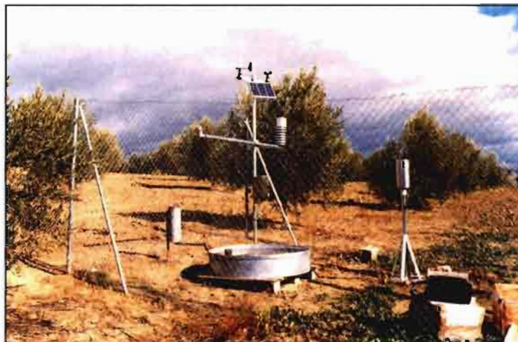
Estación meteorológica automática instalada por el Departamento de Olivicultura que suministrará datos para la programación de riegos en la región.
