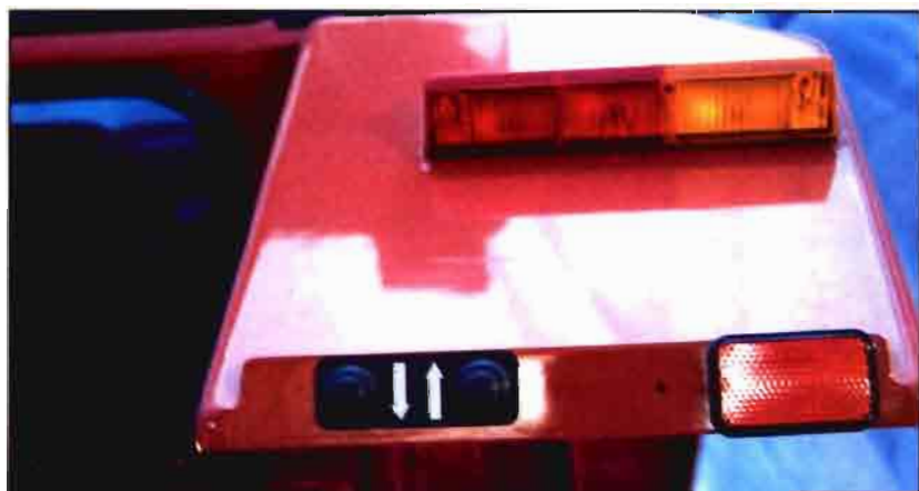
Fig. 4. Botones de mando en el guardabarros posterior para hacer subir o bajar a voluntad los brazos elevadores.
