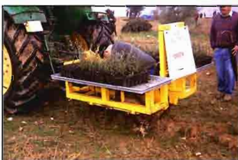
Trasplantadora FORESTA en pleno trabajo. Obsérvese al operario agachado en el momento de depositar una planta tras la reja.
