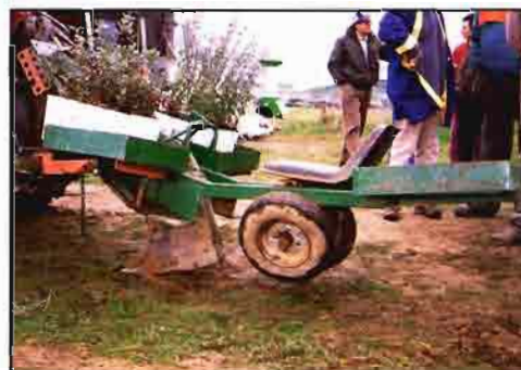
Trasplantadora COSERFO levantada para mostrar la reja que abre el surco.
