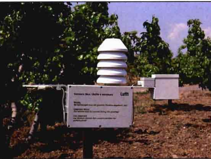
Fig. 2. Estación meteorológica automática HP-100.
