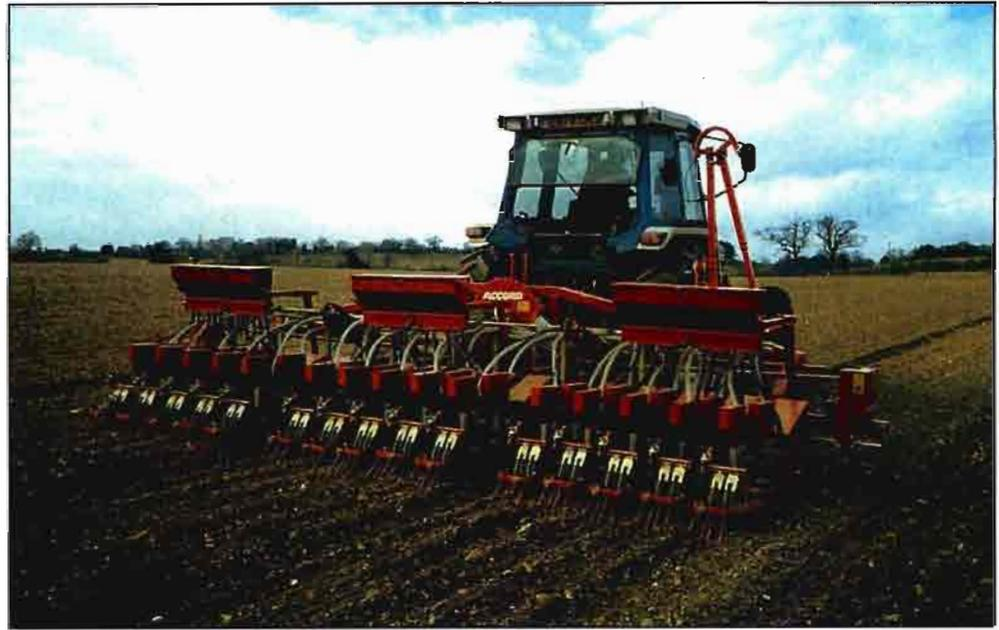
Sembradora neumática Accord Miniair, con una anchura total de trabajo de 6 m que permite combinar precisión con capacidad de trabajo.
