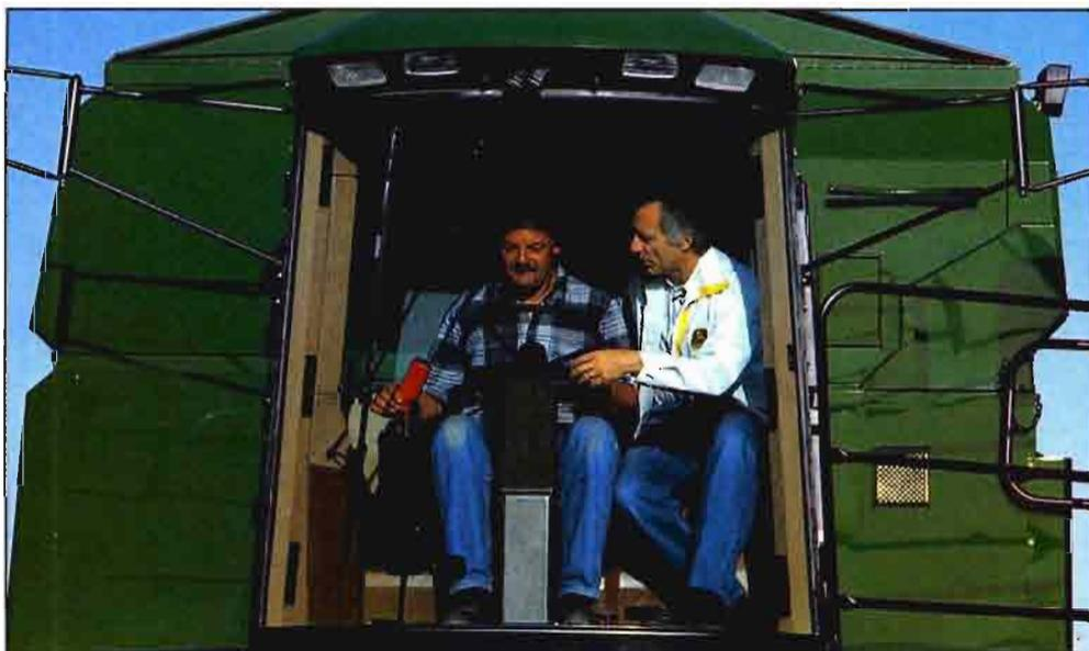
La cabina tiene un segundo asiento opcional pensando en los operarios que estén aprendiendo el manejo de la máquina. Las principales funciones que habitualmente se varían sobre la marcha se controlan con botones en la palanca multifunción de la mano derecha. El dispositivo de reglaje automático que controla diversas funciones está protegido por una tapa para que no pueda ser accionado accidentalmente.
