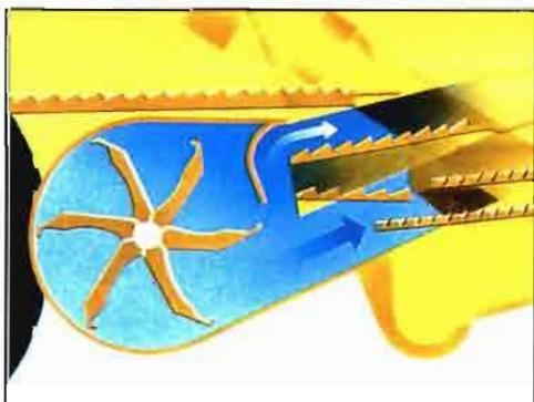
El aire del ventilador se dirige hacia las dos caídas de limpieza del grano.
