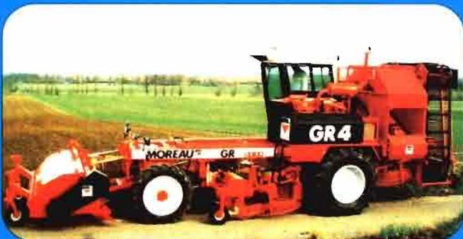
**MOREAU:** Autopropulsada para 6 filas de remolacha, equipos descompuestos a discos, a rejas alternativas y oscilantes, peladoras y cargadoras de 6 filas.
