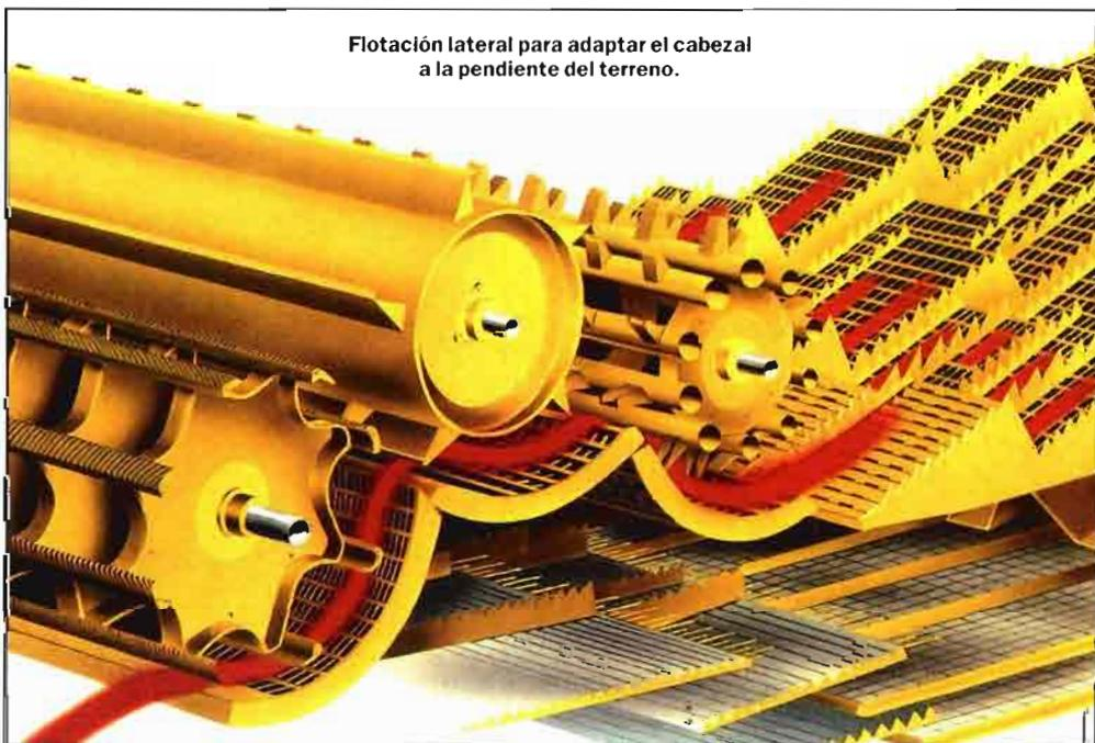
Flotación lateral para adaptar el cabezal a la pendiente del terreno.
