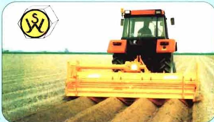
**STRUIK:** Fresadora campo plano y alomadoras para remolacha y patatas, de 2 y 4 filas.
