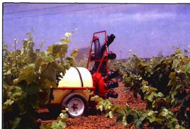
Pulverizador hidroneumático de salidas orientables individuales, LE 432 SPV de Ilemo Hardi.
