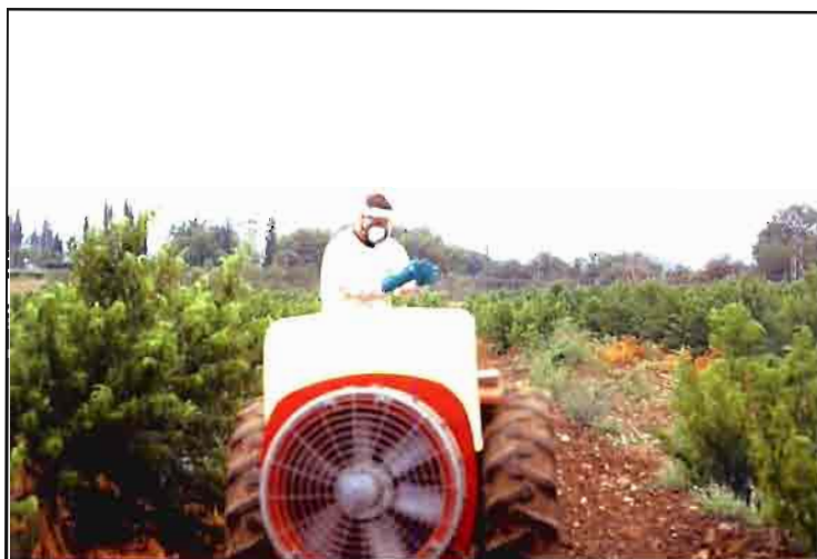
Pulverizador hidroneumático convencional, modelo LE 465, de la firma Ilemo Hardi.
