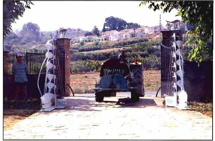
Banco de distribución vertical para ensayos de campo diseñado y construido por el Área de Mecanización Agraria de la Escuela Superior de Agricultura de Barcelona.
