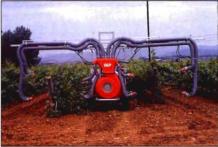
Equipo de pulverización neumática, SEP MAJOR-C. La disposición específica de los brazos, permite el tratamiento completo sobre varias hileras simultáneas.
