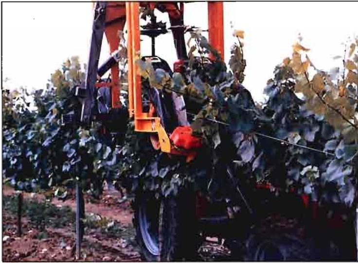
La máquina realiza la tarea de levantar los alambres atrapando entre ellos a los sarmientos.
