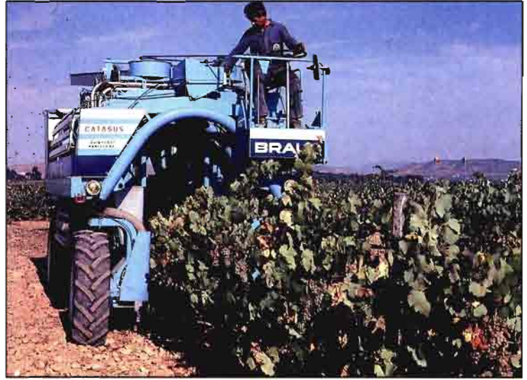
Vendimiadora autopropulsada. Uno de los primeros modelos que trabajó comercialmente en España.
