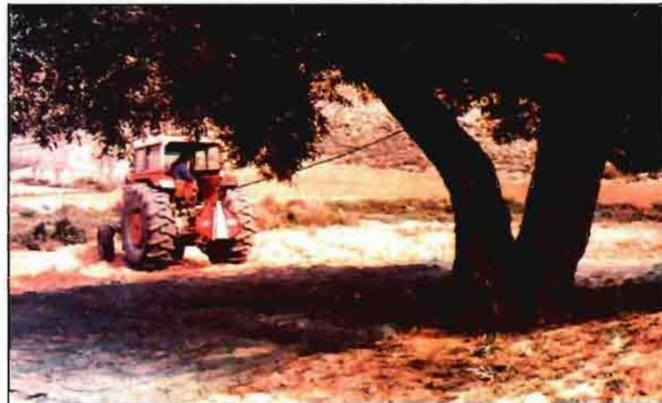
Fig. 4. Vibrador de cable recolectando aceitunas.
