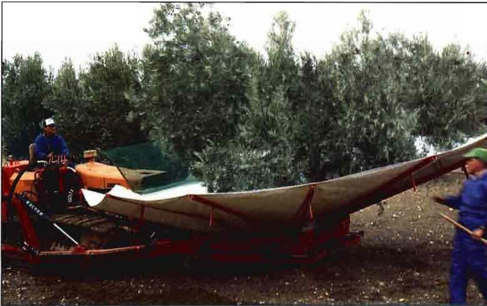
Fig. 7. Cosechadora de fruta con vibrador y paraguas invertido montados sobre tractor.
