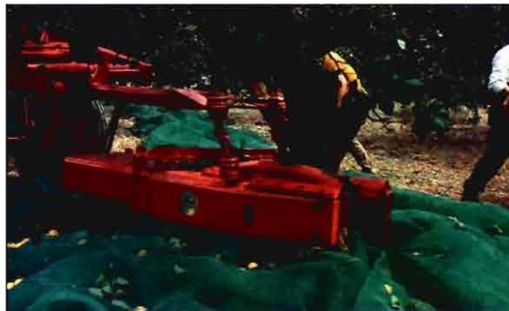
Fig. 5. Vibrador de masas excéntricas recolectando albaricoques para
