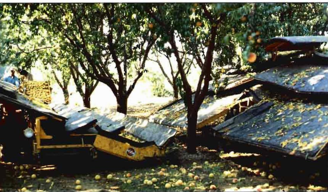
Fig. 8. Cosechadora de fruta de doble máquina recolectando melocotones.
