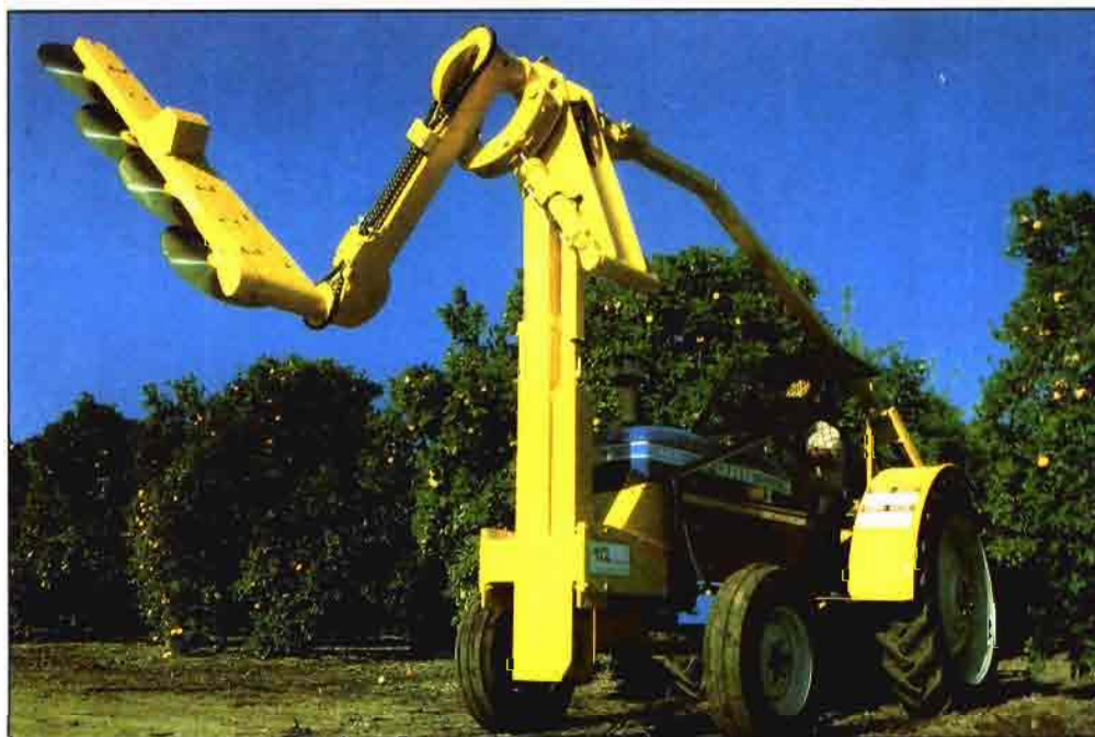
Fig. 2. Podadora de sierras circulares, que puede cortar zonas de mayor diámetro.
