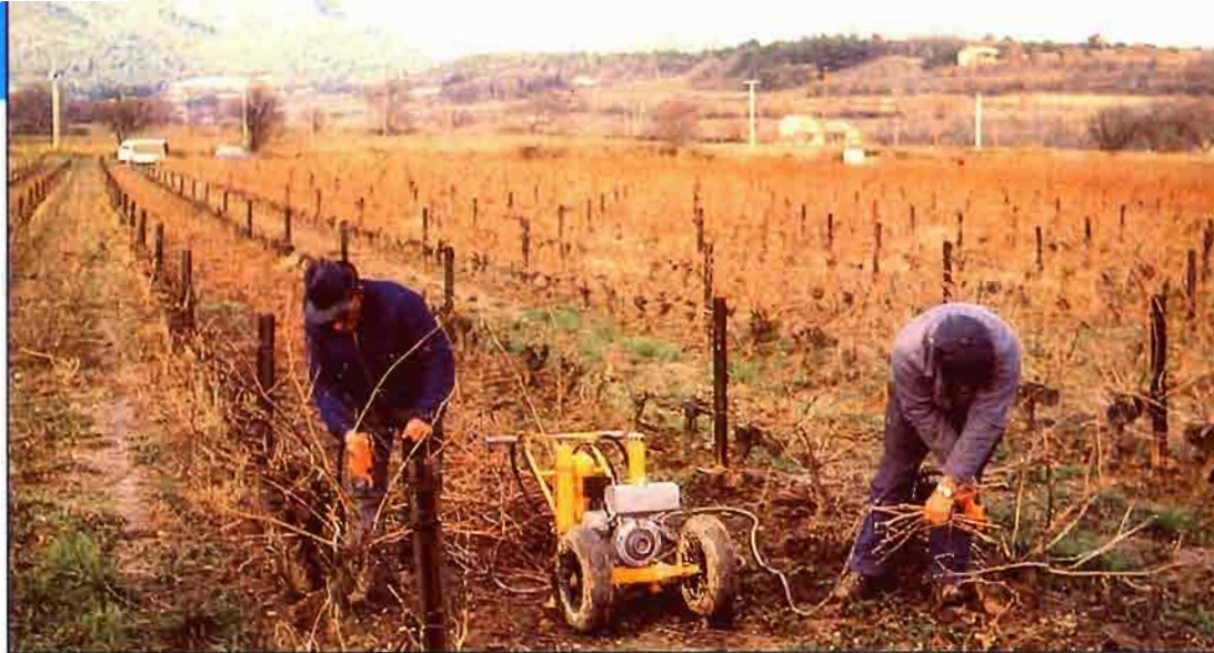
Fig. 3. Tijeras de poda con equipo hidráulico montado sobre un carrito.
