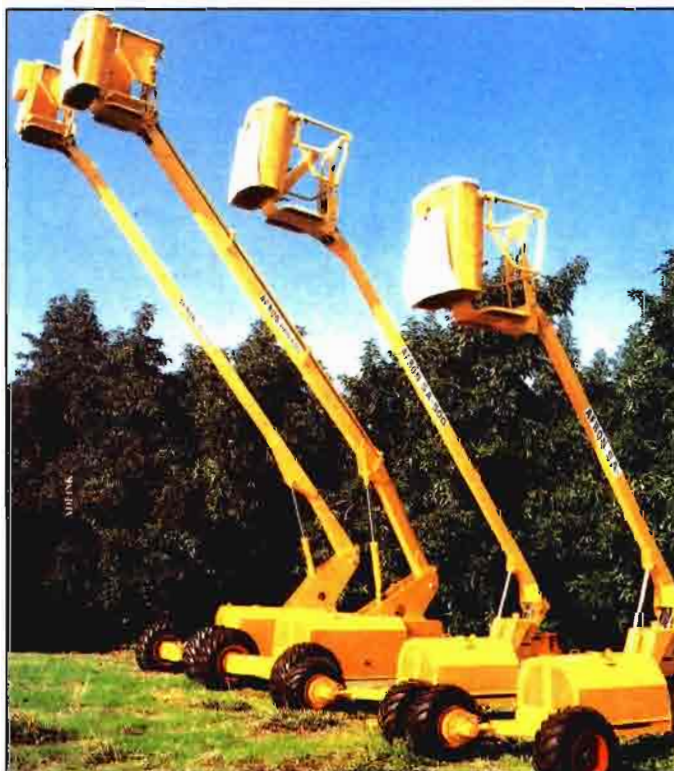
Fig. 7. Plataformas individuales que permiten acceder a la parte superior de los árboles altos para realizar diversas labores.
