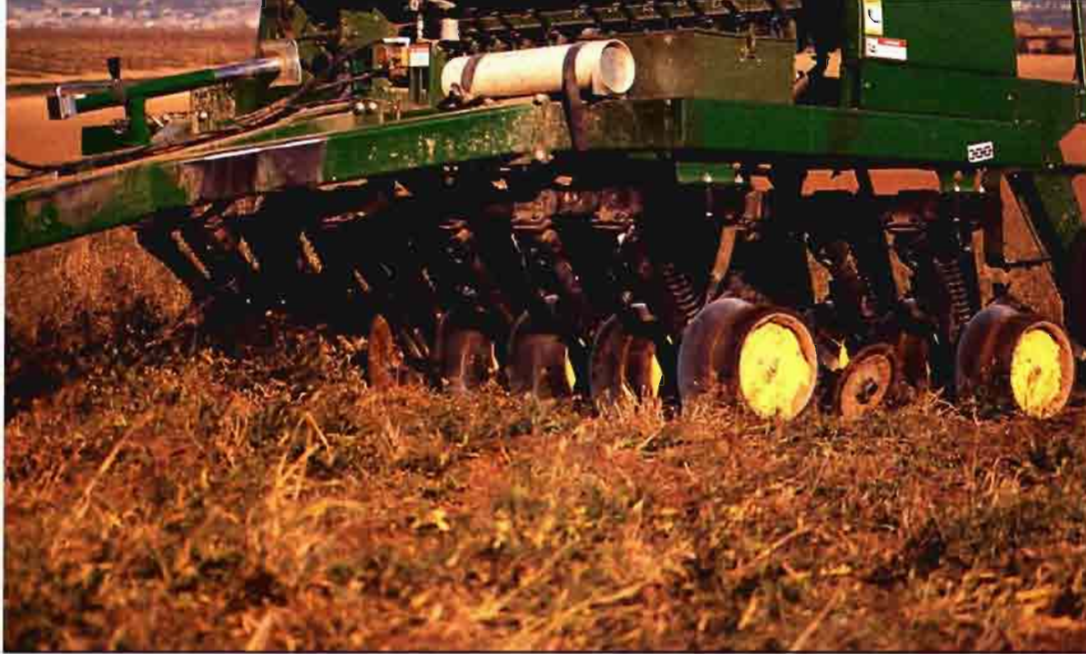
Detalle de la labor de siembra con sembradora de siembra directa John Deere, equipada con discos de apertura.
