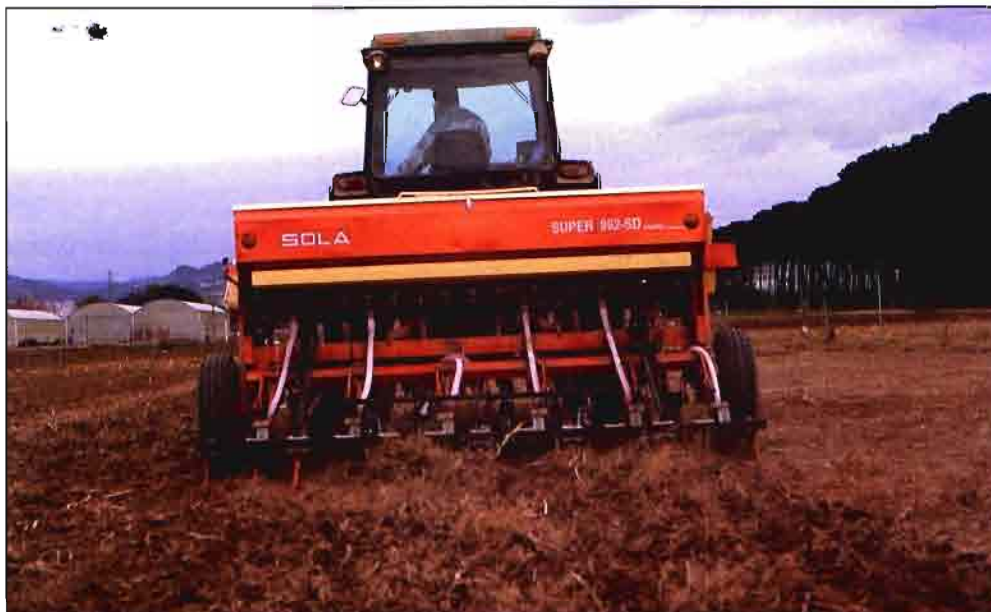
Modelo de sembradora de siembra directa SOLA, con abresurcos tipo bota.
