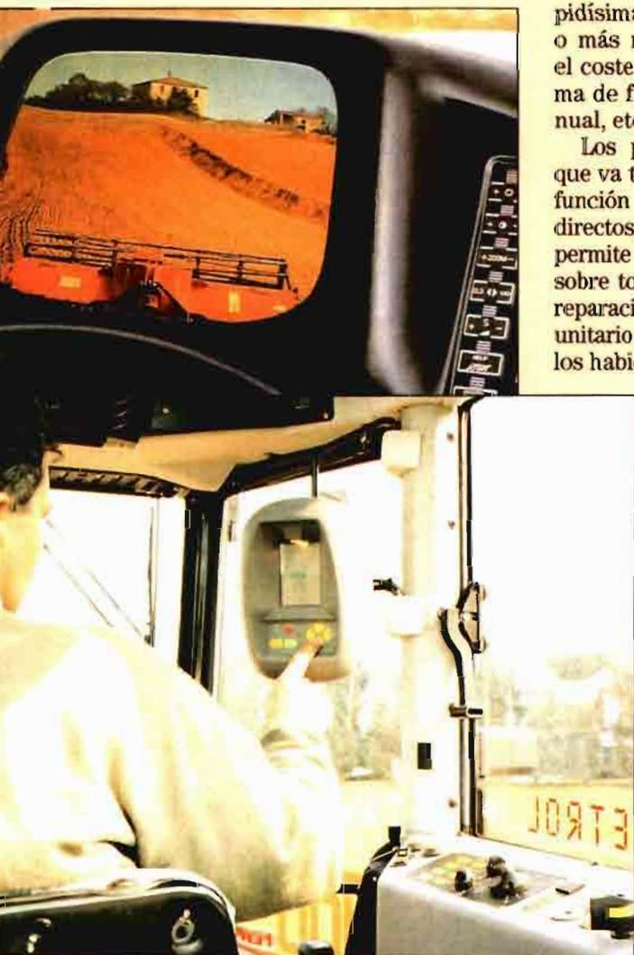
Tractor TITAN de Same con un sistema de control mediante pantalla y un ordenador a bordo que facilitan una mejora de la productividad, ofreciendo datos sobre el tractor y los aperos.
