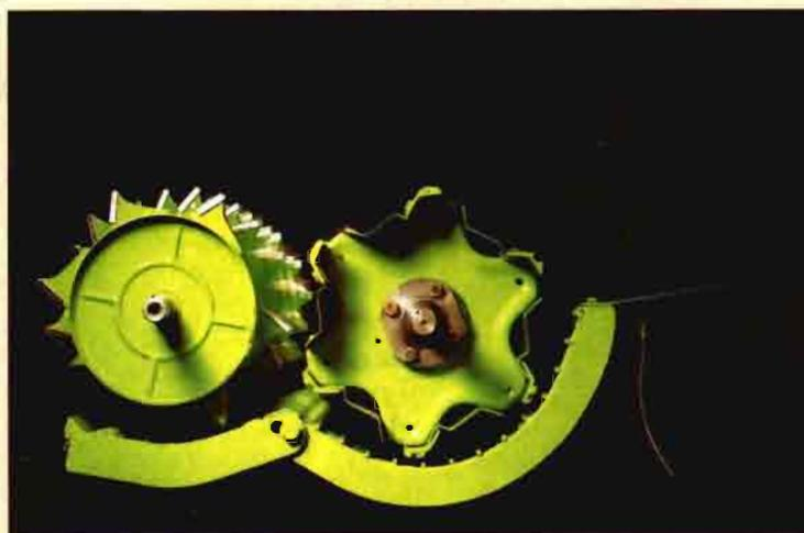
Cilindro acelerador, cilindro trillador y batidor del sistema Mega de Claas.
