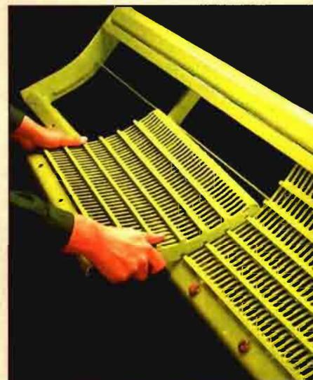
Desmontaje de los segmentos del cóncavo Claas.
