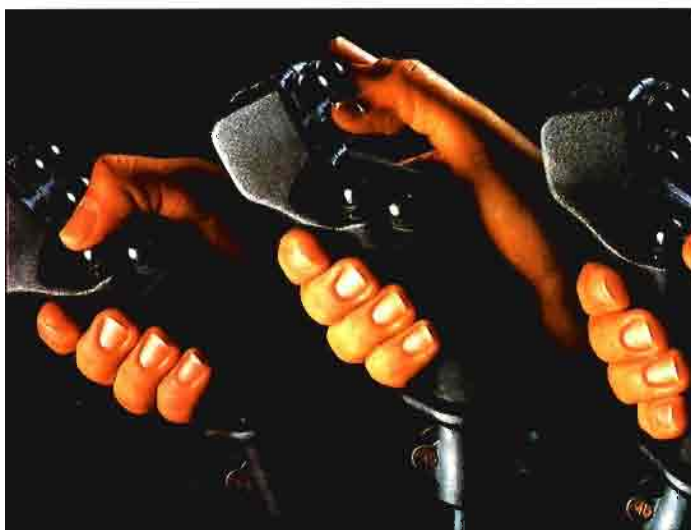
Figura 2. Palanca multifuncional en las que están los interruptores que controlan el trabajo de los principales órganos que debe manejar el conductor.
