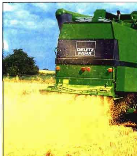
Figura 5. Mecanismo picador-esparcidor de paja montado en el extremo trasero de una cosechadora.
