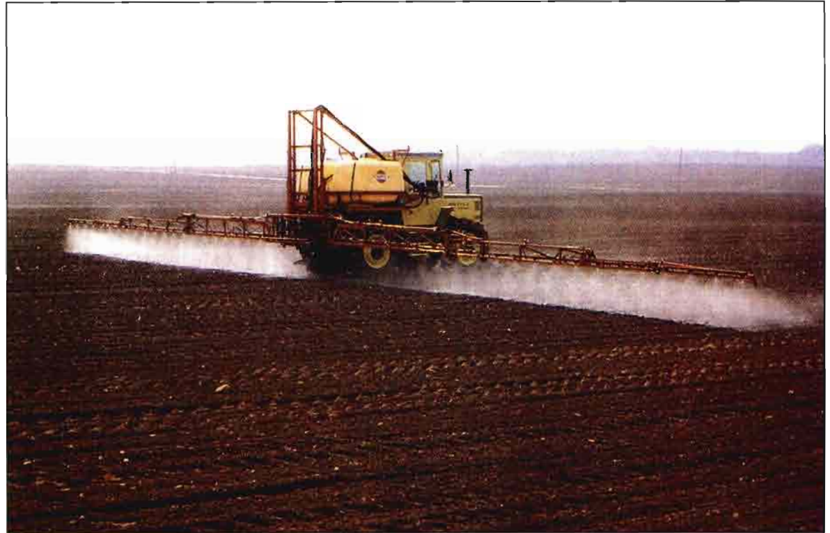
El sistema de pulverización asistida por aire para cultivos bajos, en este caso el HARDI TWIN, que será sin duda uno de los sistemas con mayor futuro.
