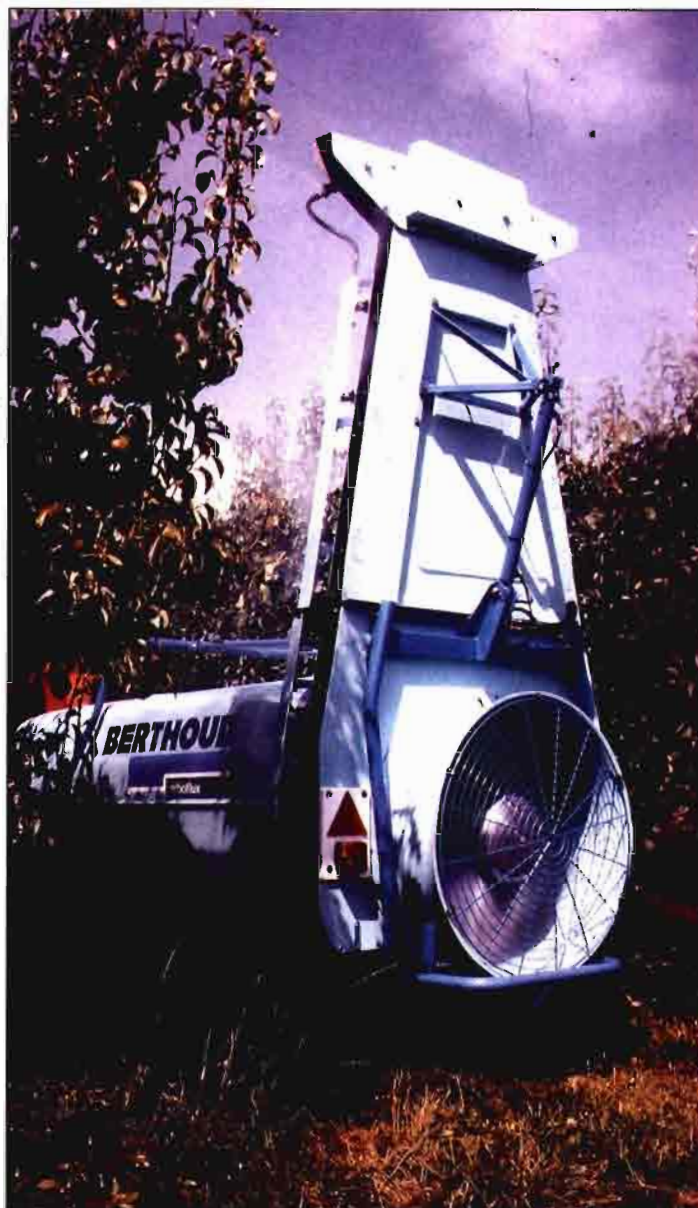
Nuevo sistema ARBOFLUX, de BERTHOUD, que hace llegar un flujo tangencial horizontalmente a la masa vegetal y que permite asimismo incidir especialmente en determinada zona de la vegetación.
