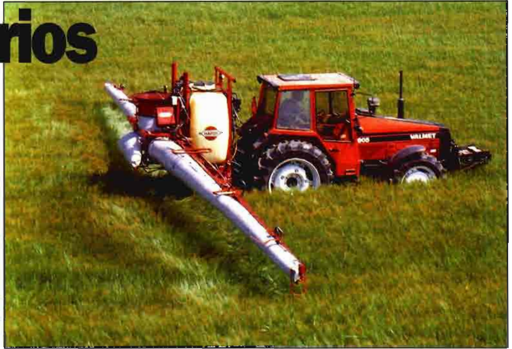
A medida que aumenta la anchura de tratamiento es más importante el sistema de nivelación de las barras, que deben permanecer paralelas al suelo.
