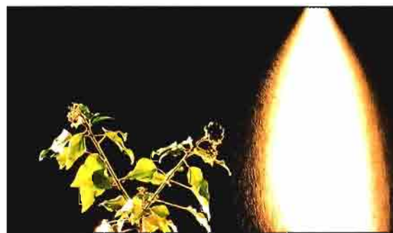
Espectaculares imágenes de la comparación de dos «espectros» de una misma pulverización, con las gotas cargadas, o no, electrostáticamente al salir de la boquilla. Fotografía del sistema EXACT de la empresa inglesa INNOVO LTD.
