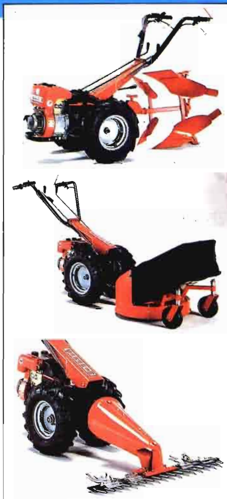
Fig. 5. Tres ejemplos de operaciones clásicas que puede realizar un motocultor, en este caso con un motor de gasolina de 4 tiempos de 5.1 kW: arado de vertedera, cortadora de césped y barra segadora alternativa.
