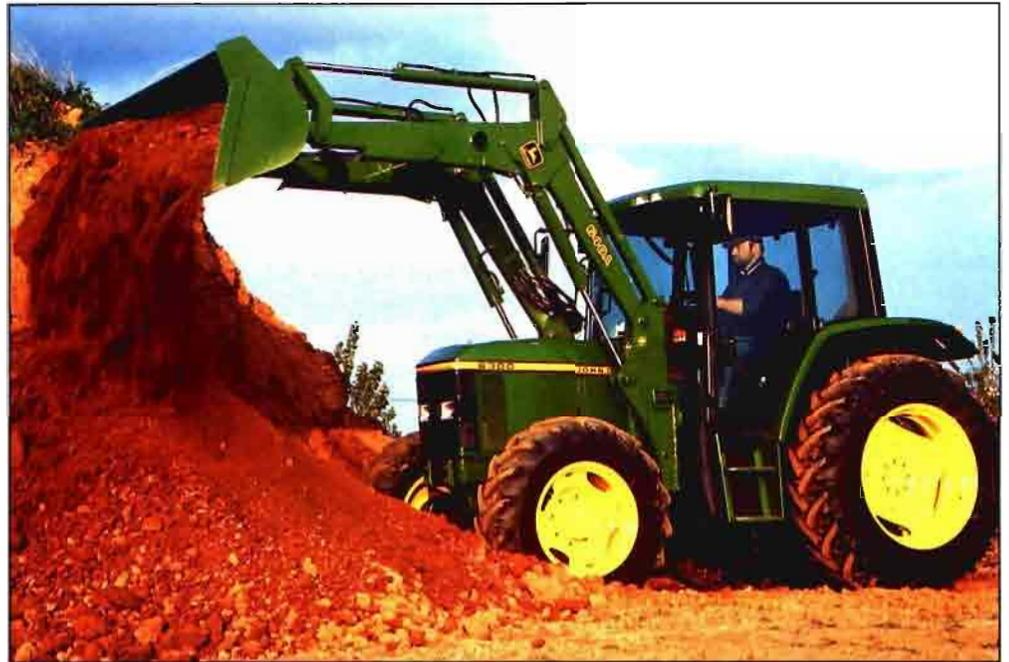
**Pala cargadora, montada en la posición frontal del tractor, auxiliar insustituible en muchas explotaciones.**
