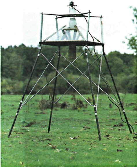
Fig. 19.—Trampa de luz modelo Rothamsted.
