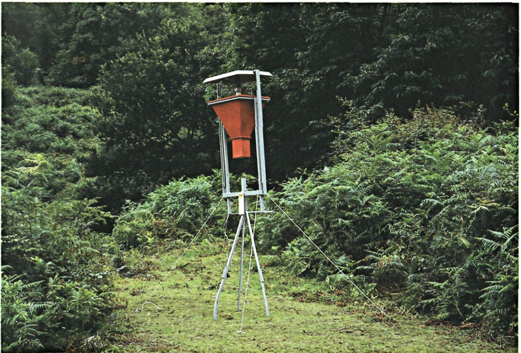
Fig. 18.—Trampa de luz de doble tolva.
