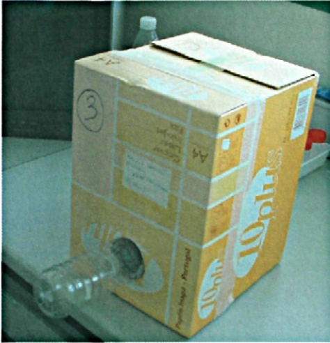
Figura 1: Evolucionario compuesto por una caja de cartón de 22 x 30 x 22 cm y una botella de PVC transparente de 250 ml.
