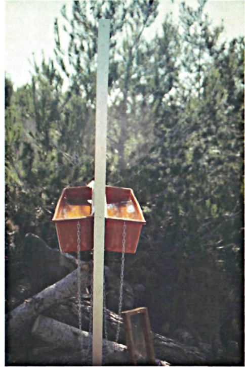
Foto 2.—Vista de perfil de la Trampa ventana en la que se puede observar los recipientes en los que se capturan los escolítidos.
