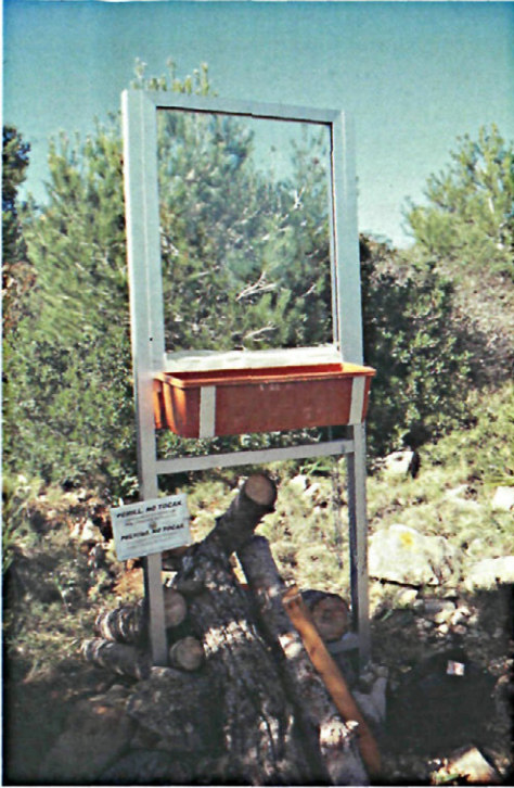
Foto 1.—Trampa ventana utilizada con trozas frescas apiladas en la base.
