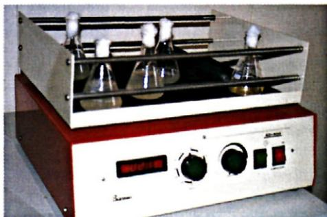
Fig. 3.—Agitador rotatorio con frascos Erlenmeyer en los que se obtienen esporas de los hongos de la grafiosis.
