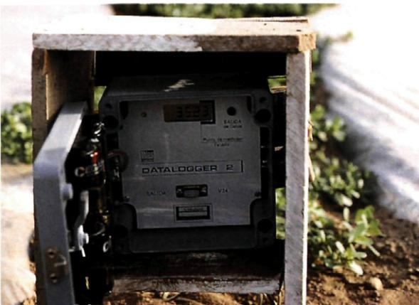
Fig. 3.—Termómetro digital electrónico utilizado para medir la temperatura del suelo (Foto: J. J. Moreno).
